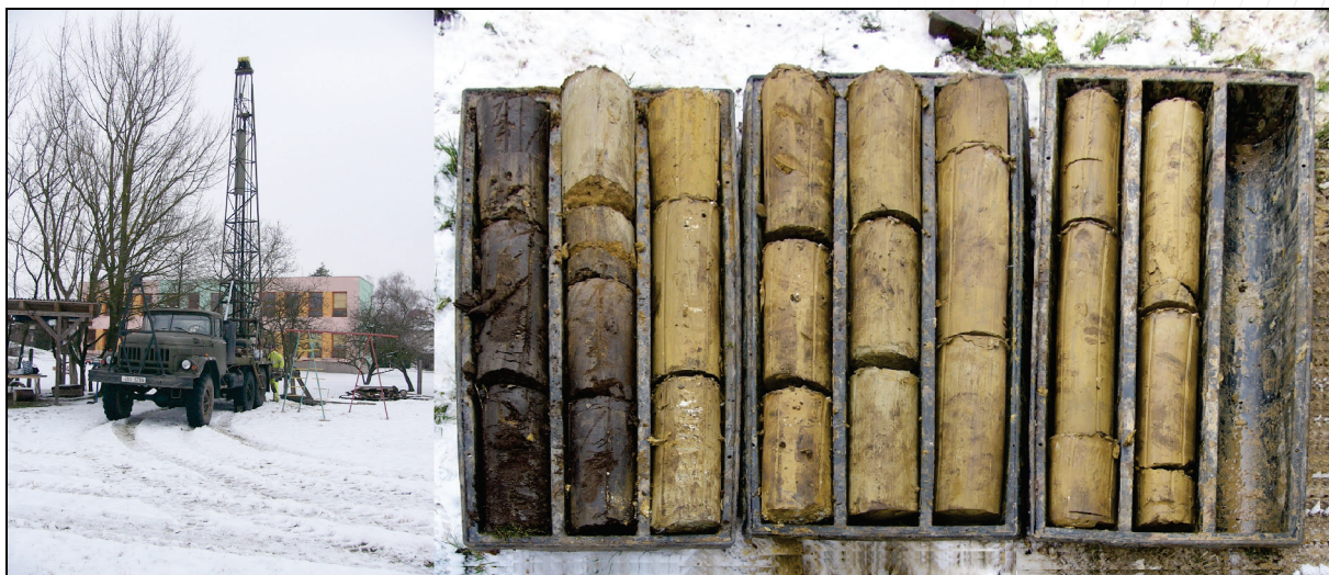
vrt PV-3 (situování a hmotná dokumentace)
